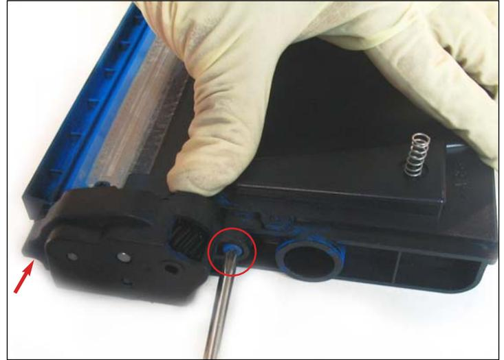
**REMOVING THE GEAR-SIDE END PLATE**
