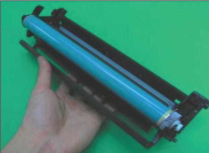
**INSTALLING THE OPC DRUM**
